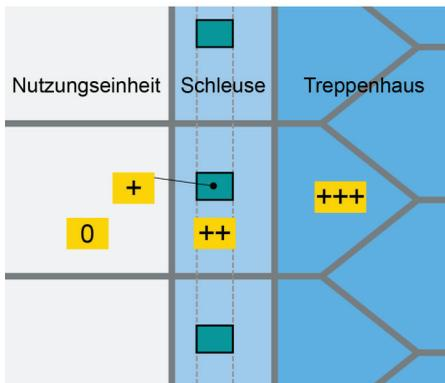
RDA mit Abführung des Überdrucks via Parallelschacht zur Schleuse
