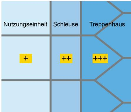
RDA mit Druckkaskade vom Treppenhaus zur Nutzungseinheit
